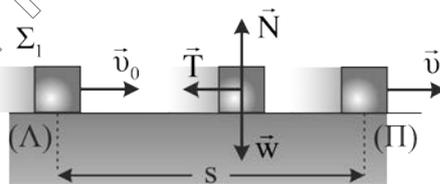
$$W_T = K_{\text{τελ}} - K_{\text{αρχ}} \text{ ή } -T \cdot s = \frac{1}{2} m_1 \cdot v_1^2 - \frac{1}{2} m_1 \cdot v_0^2 \text{ ή } -\mu \cdot N \cdot s = \frac{1}{2} m_1 \cdot v_1^2 - \frac{1}{2} m_1 \cdot v_0^2 \text{ ή } -64 = v_1^2 - 100 \text{ ή } v_1 = 6 \text{ m/s}.$$
